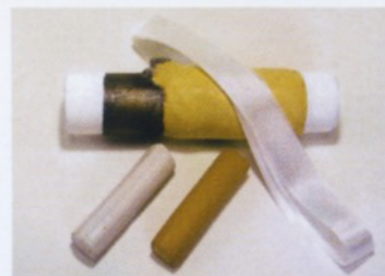
グラス、ファイバーを配水管に巻き付けて、保護のために☆(ユニボンドパテ)を約5mmの厚さに塗ったもの。
